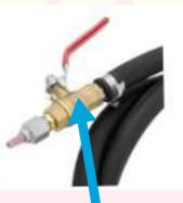
Attention : La vanne de bout de lance ne doit pas servir pour la mise en route ou l'arrêt de la machine lorsque celle-ci est sous pression.
